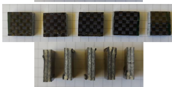
Fig. 5.10. Curbele efort/deformare și imaginile epruvetelor testate (compresiune) – FM
