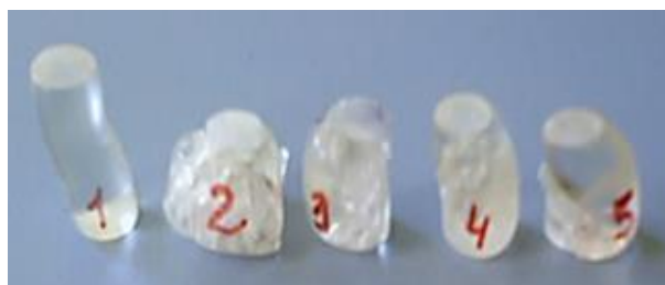
Fig. 5.1. Curbele efort/deformare pentru rășinile studiate și imaginile epruvetelor testate (compresiune)
