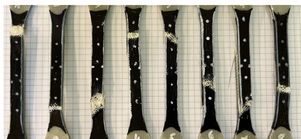
Fig. 4.4. Curbele \sigma/\epsilon și epruvetele testate pentru materialele AM
