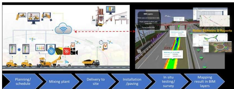
Fig. 2.19. Colectarea automată a datelor și monitorizarea conformității în timpul desfășurării procesului de construcție al unei autostrăzi [47]
