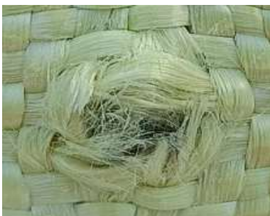
Figura 5.39. Detaliu al stratului 1 (țesătură Twaron CT), Foc A, al panoului cu 32 straturi de țesătură Twaron CT736, vedere din spate
