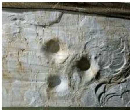
a) 32 straturi de țesătura Twaron CT736 b) 16 straturi de țesătura Twaron CT736
