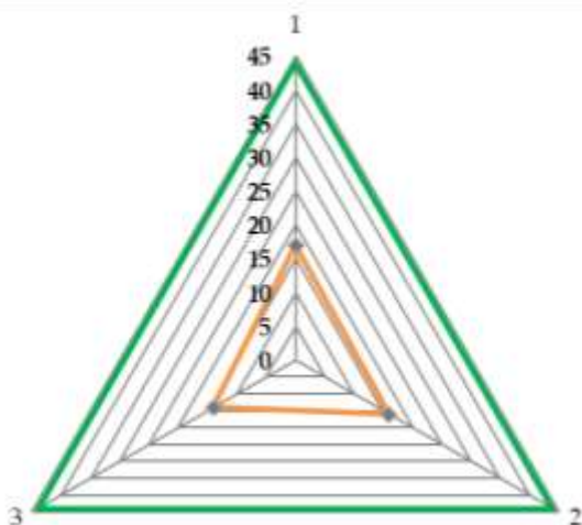
Figura 5.33. Rezultatele adâncimii urmei pentru panoul format din 32 straturi de țesătură Twaron CT736
