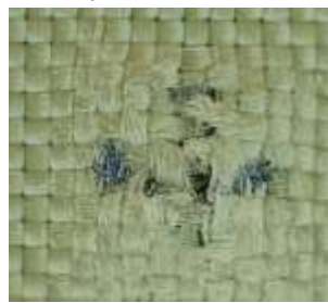
Figura 5.36. Detaliu al stratului 1 (țesătură Twaron SRM509), Foc A, al panoului cu 16 straturi combinate de țesătură Twaron SRM509, vedere din spate
