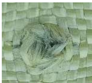
Figura 5.35. Detaliu al stratului 1 (țesătură Twaron CT), Foc A, al panoului cu 16 straturi de țesătură Twaron CT736, vedere din spate
