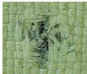
Figura 5.40. Detaliu al stratului 1 (țesătură Twaron SRM509), Foc A, al panoului hibrid cu 32 straturi, vedere din spate
