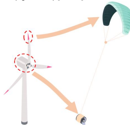
Figura 5.2 Ideea fundamentală a sistemelor AWES cu un generator la sol.
