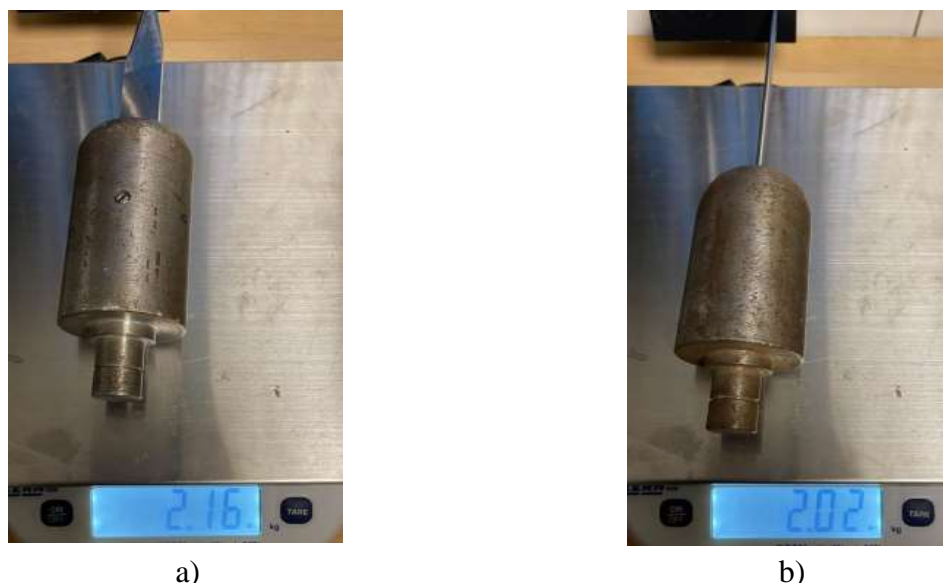
Fig. 4.13. Masa impactorului (a) cu cuțit S1, (b) cu țepușă (în kg)
