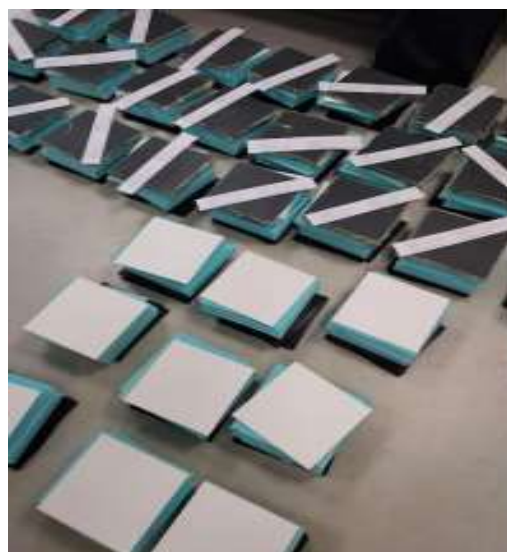
Fig. 4.9. Pregătirea probelor pentru testare pe mașina Instron 9340
