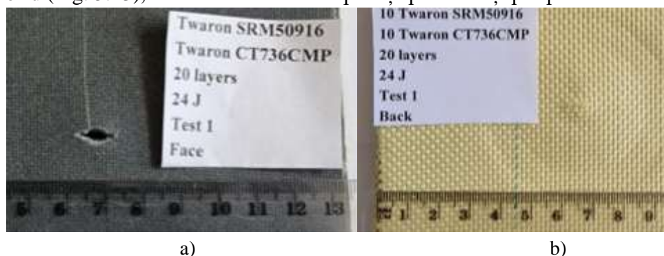
Fig. 5.23. Fotografii ale panoului hibrid (130 mm x 130 mm) cu 10 straturi de Twaron SRM 509 și 10 straturi de Twaron CT736 CMP: a) față, b) spate
