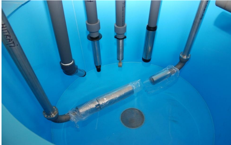
Foto 4.4 – Foto original, montajul senzorilor în incinta de creștere
