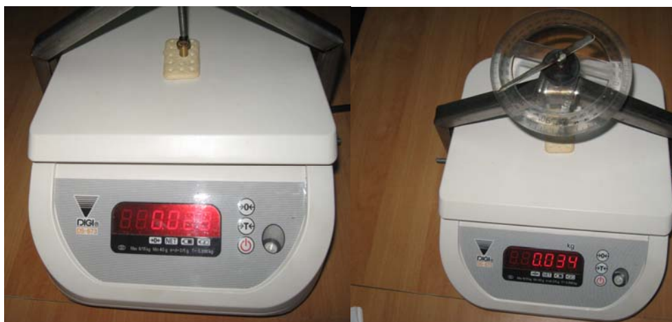
Fig 2.4 Aparat pentru determinarea rezistenţei la biscuiţi.
