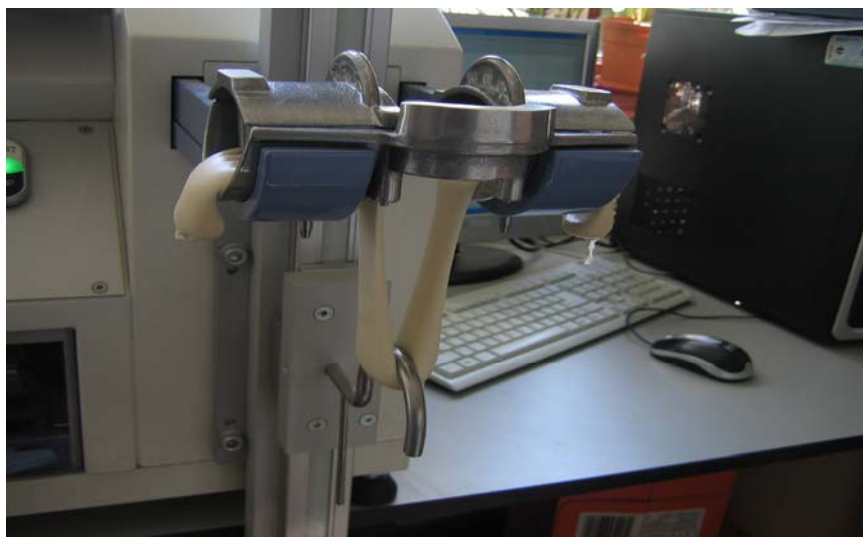
Fig.3.1 Comportarea aluatului la încercarea trasării extensogramei
