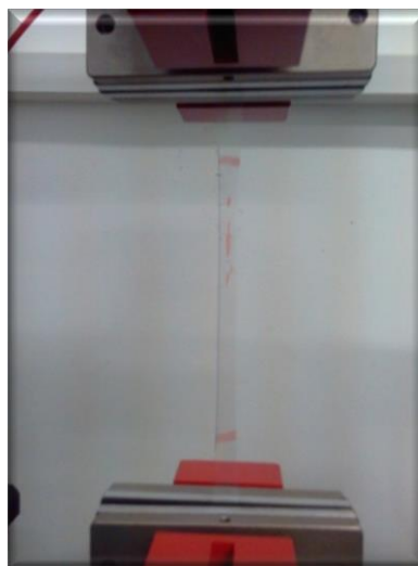
Figura 4.15. Alungirea la rupere a epruvetei de film V
