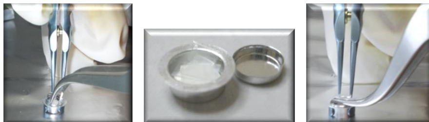
Figura 4.16. Introducerea probei în creuzet și fixarea capacului în vederea analizei DSC
