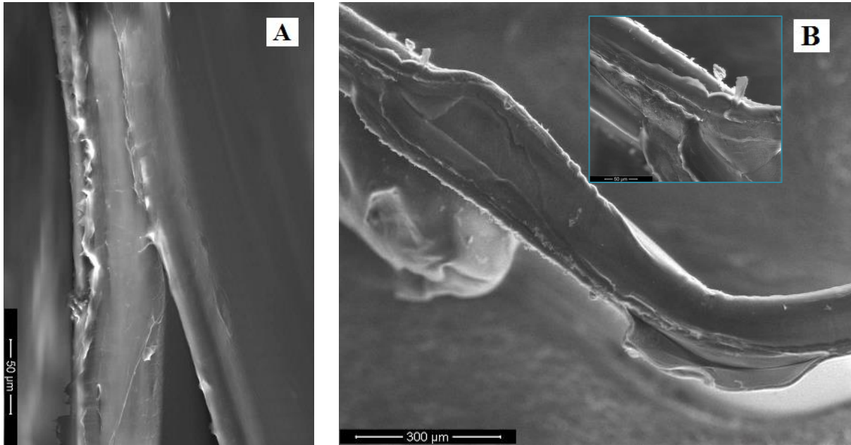
Figura 6.3. Detalii zone de delaminare observate la SEM în secțiunile filmelor multistrat PTM3 (A), PTM6 (B)
