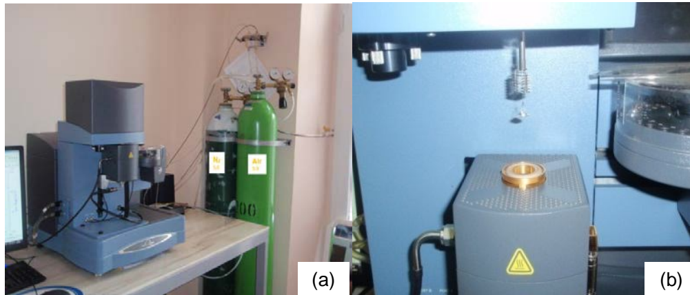
Fig.2.9 Echipament mTGA Q5000 IR pentru analiza termogravimetrică(a), detaliu din zona cuptorului (b),
