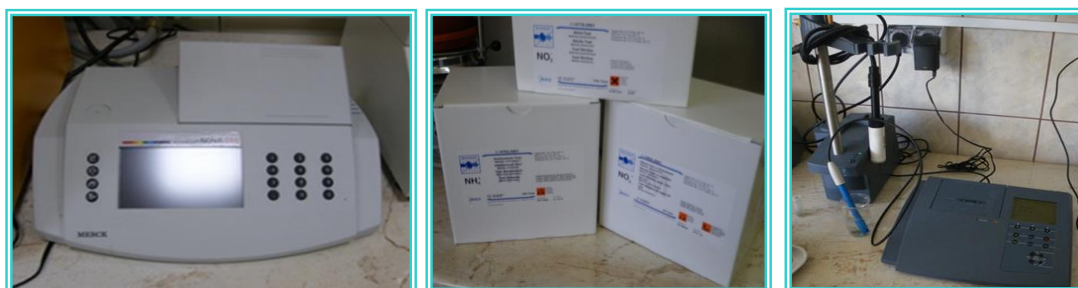
Foto 2.6. Spectrofotometrul Spectroquant Nova 400, kit-uri compatibile Merk și pH metru WTW model 340
