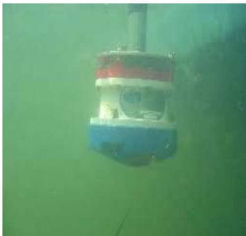
Figura 6.1. Imagine subacvatică a curentmetrului montat lateral de barca
