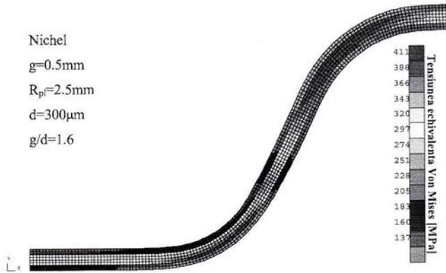
Figura 7.16. Distribuția tensiunii echivalente Von Mises în secțiunea micro-pieseii modelate utilizând poansonul cu geometrie cilindrică
