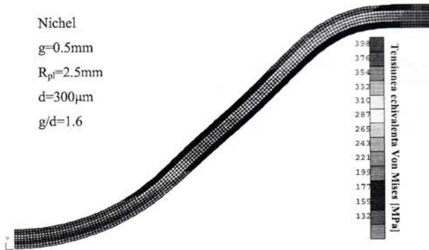
Figura 7.16. Distribuția tensiunii echivalente Von Mises în secțiunea micro-pieseii modelate utilizând poansonul cu geometrie cilindrică
