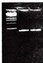
Figura 3.9 Electroforeza în gel de agaroză 1 % a ampliconilor genei lcnB obținuți în urma reacției PCR. Linia 1-markerul molecular de 1 Kb; Liniile 2 și 3 ampliconii genei lcn B cu lungimea de 200 pb
