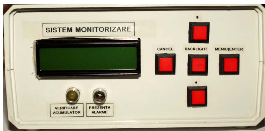
Figura 3.56. Partea frontală a carcasei cu elementele de interfață directă instalate.
