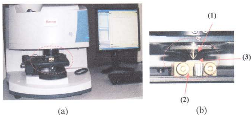
Figura 5.12 – Microscopul FTIR Thermo Scientific Nicolet iN10 MX cu vedere de ansamblu (a) și zona de contact (b) dintre cristalul de Ge (1) și proba (3), fixată în suportul (2).
