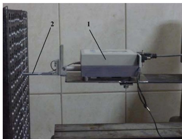
Fig. 6.32. Măsurarea rugozităţii: (1) Profilometrul Surtronic 3+; (2) Poziţionarea palpatorului
