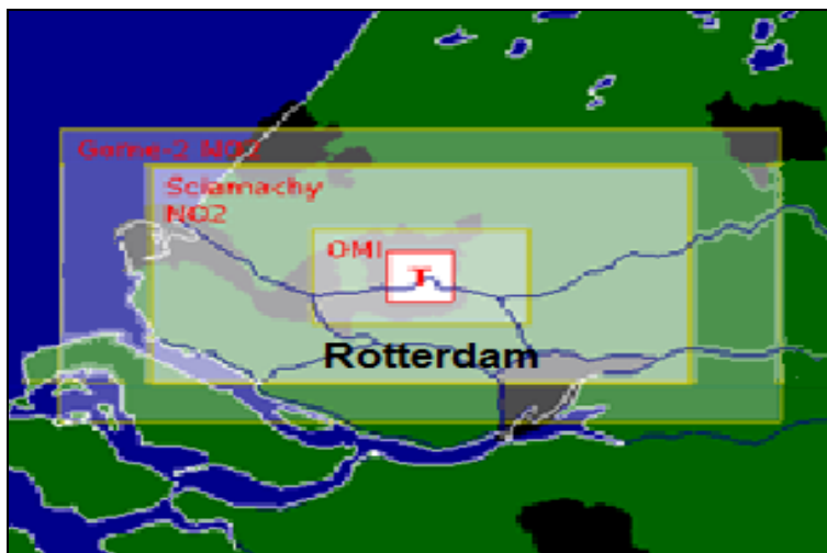
Figura 4.2: Acoperirea spațială a pixelilor instrumentelor satelitare DOAS utilizate în monitorizarea NO 2 . Comparație efectuată deasupra orașului Rotterdam, Olanda. (adaptată după http://www.tropomi.eu )
