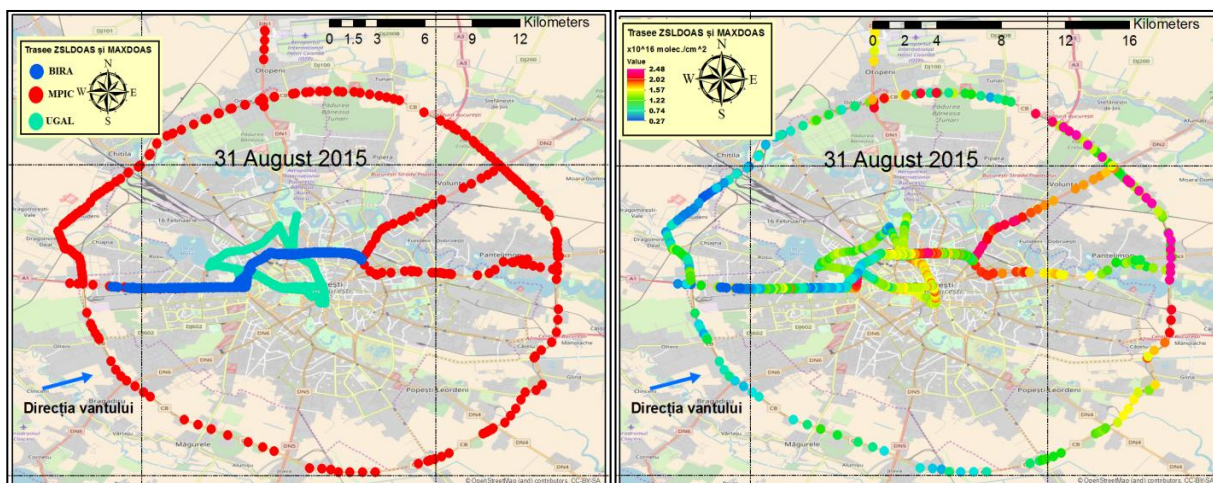
Figura 4.27: Comparația între VCD tropo NO 2 detectat de sistemul MAX - DOAS MPIC și sistemele ZSL - DOAS UGAL și BIRA în ziua de 31.08.2015 în intervalul orar 09:00 - 14:00 UTC (stanga). Traseul celor trei sisteme DOAS (dreapta).
