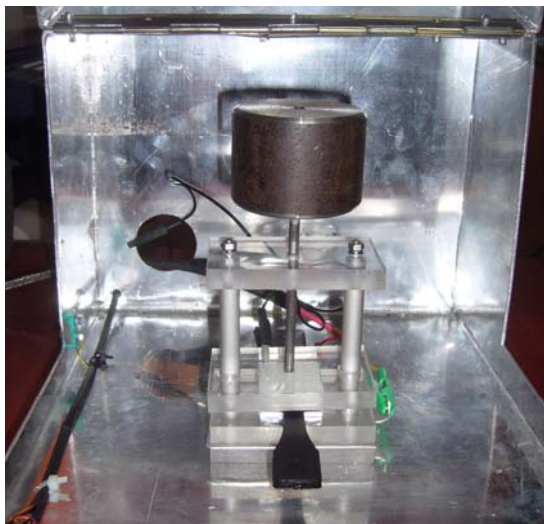
Figura 3.5. Celula pasivă pentru măsurarea rezistenței electrice a probelor subțiri.
