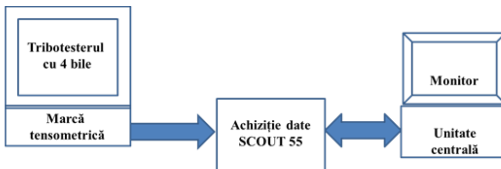
Fig. 4.2. Schema ansamblului care conține sistemul de achiziție a datelor
