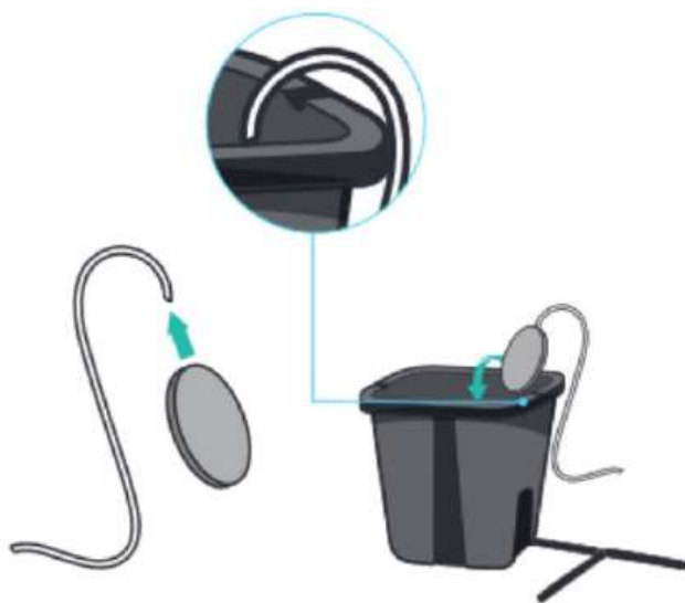
Figura 2. 3 Sistemul de aerare din modulul aeronic de creștere.
